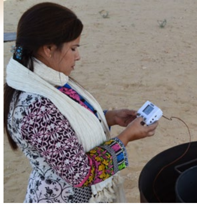
عند إنتاج الفحم الحيوي، تُضبط درجة الحرارة باستخدام المزودة الحرارية.
